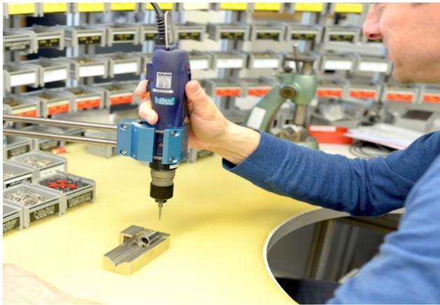
Abbildung 1. Zusammenbau von Schliesszylindern
